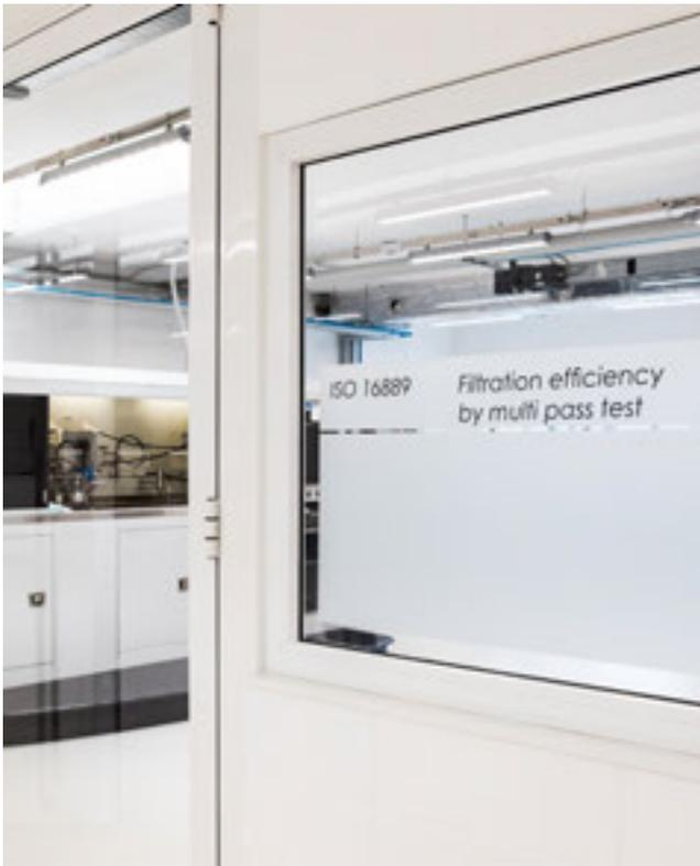
过滤器特性验证测试按照国际标准在受控且过滤气候室内开展，再现了任何液压回路的压力和流量的操作条件。
