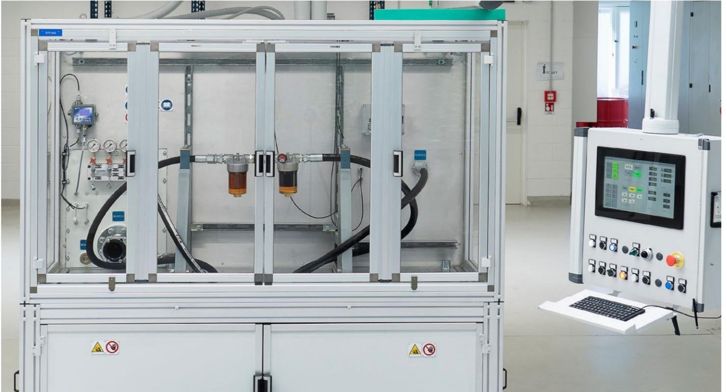
所使用的特定液压系统和测量仪器能够测量和记录过滤器遇到液流时产生的电位（单位：kV）。
